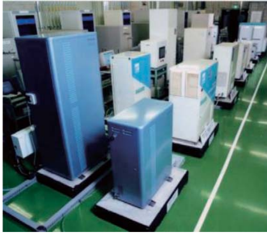
PEFC コージェネシステムの運転試験 (Vol. 1-2) (提供: 日本ガス協会)
