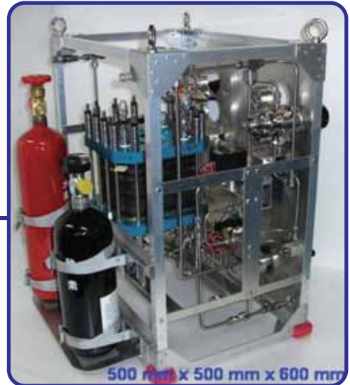
観測気球搭載予定の 100W 級 FC システム (宇宙航空研究開発機構)
