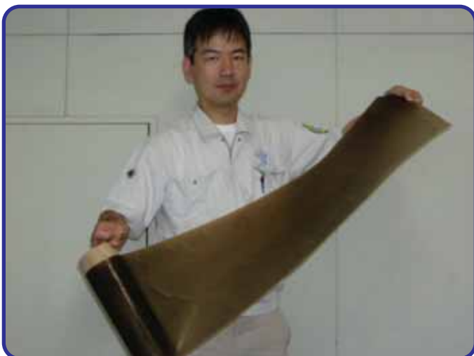
無機／有機複合電解質膜（W/PVA 膜） （ニッポン高度紙工業）
