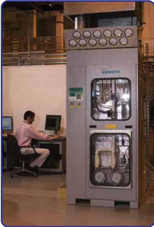
5.5kW DC 出力定置用 SOFC (Siemens Power Generation)
