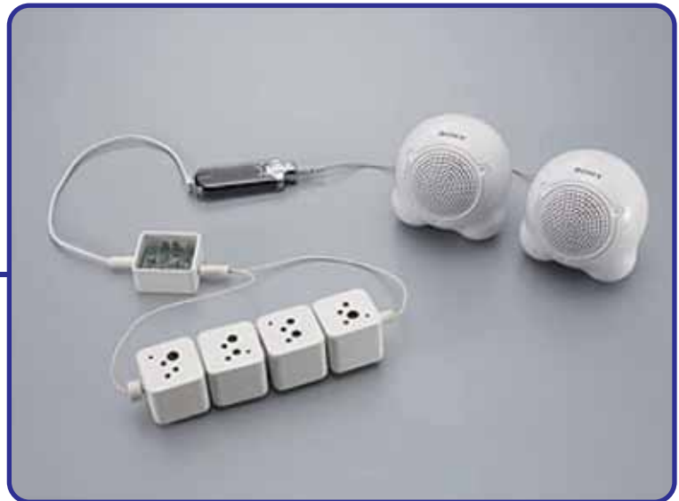
バイオ電池によるウォークマンの デモンストレーション (ソニー株)
