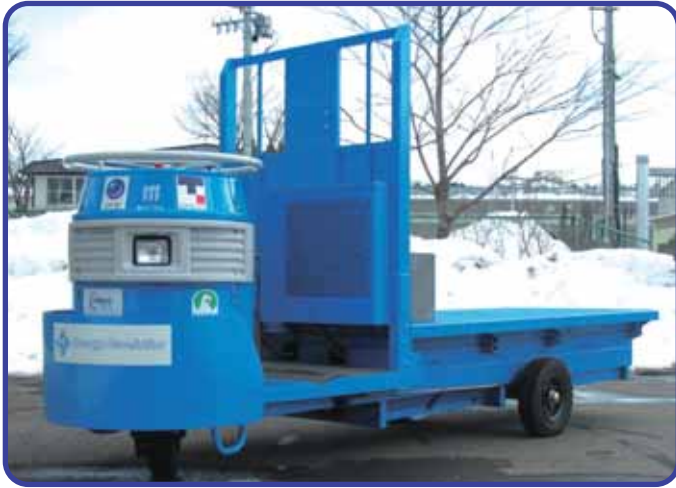
試作燃料電池ターレット車 (東京ガス、JFEコンテナ、関東農機)
