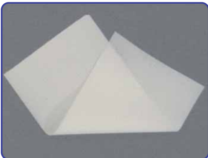
ガラス/セラミック複合ガスシール材 (ファインセラミックスセンター)
