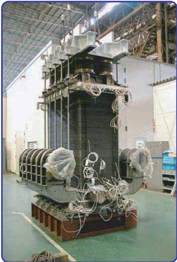
積層が完了したMCFC300kW級スタック (MCFC組合)
