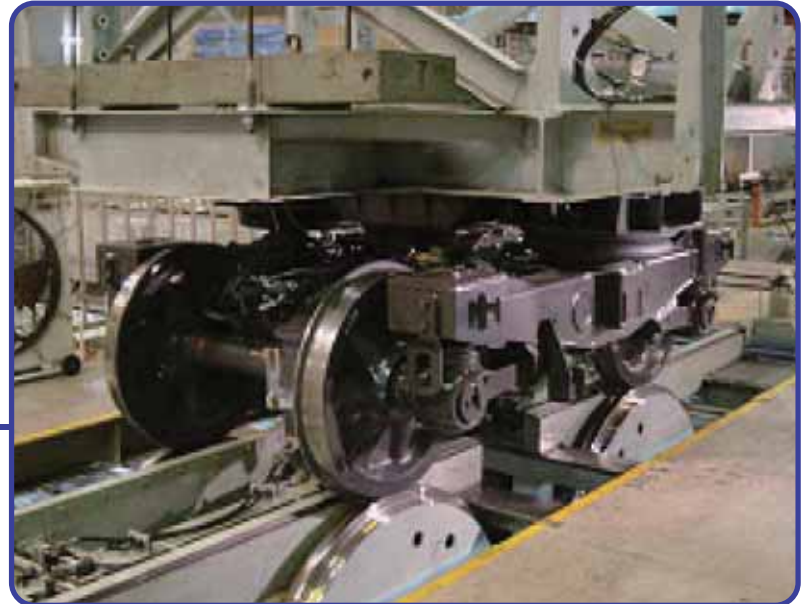
燃料電池による台車駆動試験状況 （鉄道総合技術研究所）
