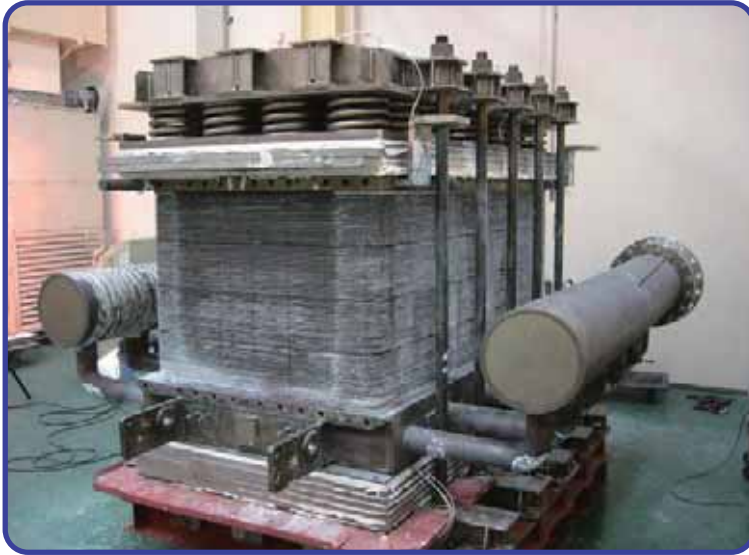
125 セルを積み上げた MCFC 高積層・大容量スタック (石川島播磨重工業)
